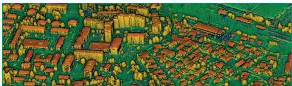
Fig. 1 - Nuvole di punti dense generate da fotogrammetria (a) o laser scanner (b).
